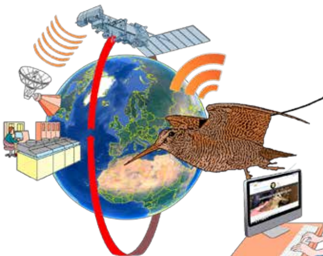
Les balises Argos alternent des périodes d'émission de 10 heures et des périodes de "sommeil" de 48 heures pendant lesquelles les capteurs solaires permettent de recharger les batteries de la balise.
